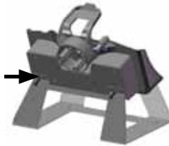
3. Auf der oberen Vorderseite der Schreibtisch-Basis und der unteren Vorderseite des Docks befinden sich zwei kleine Schraubenbohrungen, eine auf der linken und eine auf der rechten Seite. Richten Sie die Bohrungen aufeinander aus, setzen Sie Schrauben in die Bohrungen ein, schrauben Sie sie ganz hinein und ziehen Sie sie fest an. Die Schreibtisch-Basis ist nun einsatzbereit.
