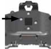
2. Richten Sie auf der Rückseite des Docks eine der RAM-Halterungsbasen mit den Schraubblöchern aus.
