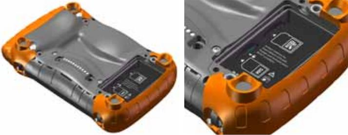
Um die SIM-Karte zu entfernen, schieben Sie den Verschluss nach rechts. Drücken Sie kurz auf die Karte, um sie teilweise auszuwerfen. Eventuell benötigen Sie eine Pinzette oder eine Nadelzange, um die Karte greifen zu können und sie zu entfernen.
