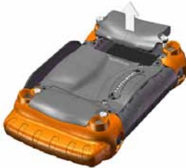
2. Platzieren Sie den/die Li-Ionen-Akku(s) in das/die Fach/Fächer. Stellen Sie sicher, dass die Anschlüsse des/der Akkupacks mit den Anschlüssen in dem/den Fach/Fächern übereinstimmen.
